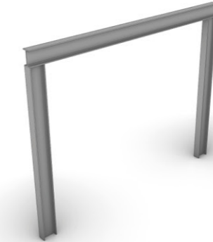
Struttura portante realizzata con travi IPE
