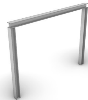
Struttura portante realizzata con travi HEA
